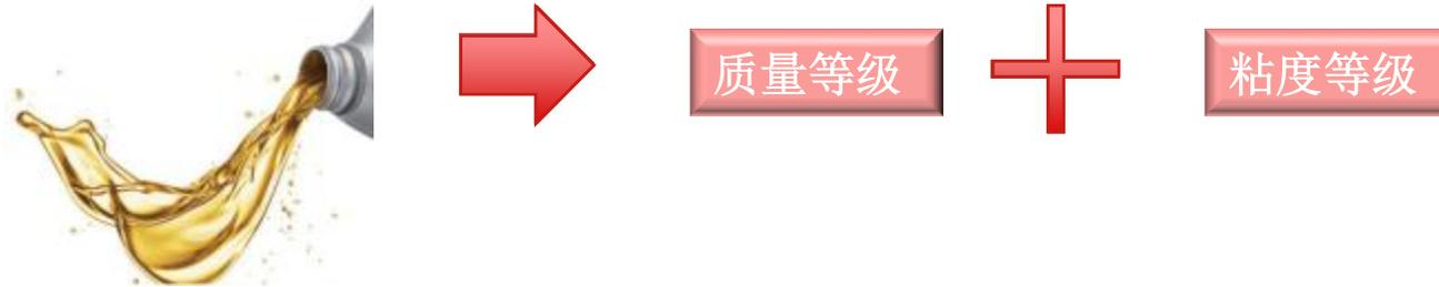
机油使用过程中主要注意两个参数，即机油的质量等级和机油的粘度等级，质量等级评定的机油的质量的好坏，粘度等级规定机油适用的温度范围
