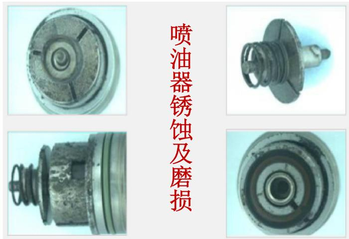
喷油器锈蚀及磨损
