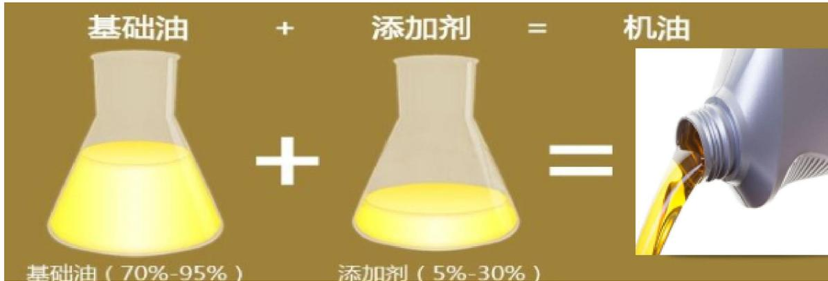
机油由基础油加添加剂构成
